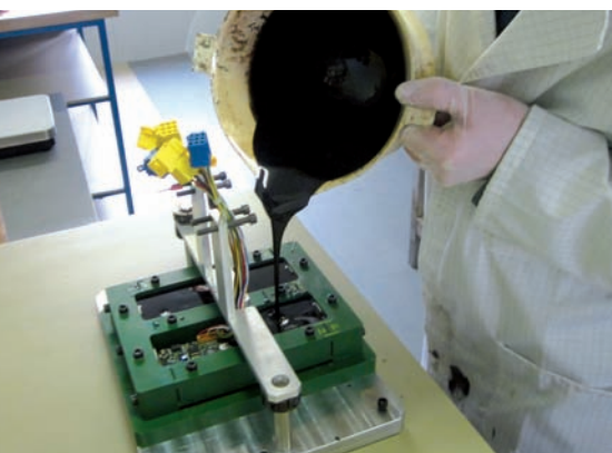
>>> Résinage de cartes électroniques
